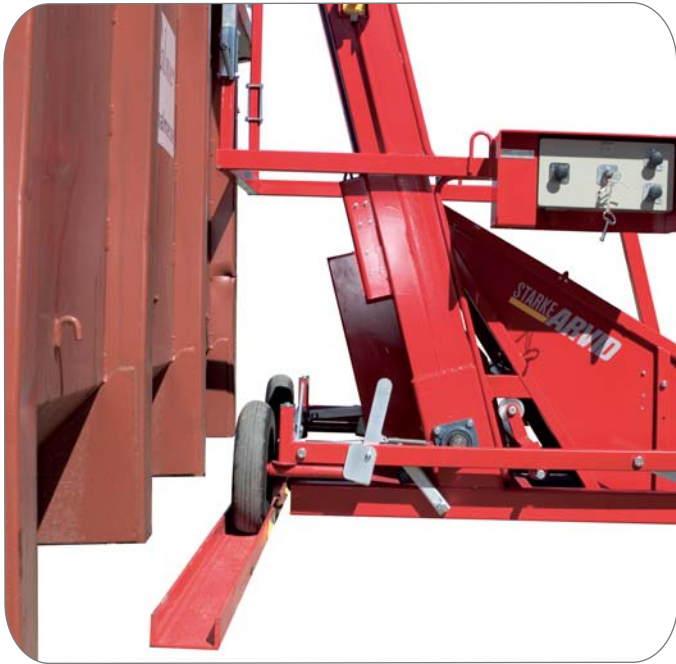
Sivuttain liikuttaminen U-profilin avulla
