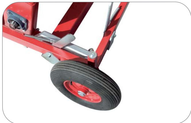
90° kääntyvät pyörät eteenpäin ja sivuttain liikuttamista varten Neutraali-asento
