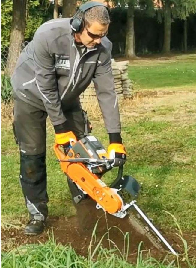
Abbildung 5-3: Grabenfräse GeoTrencher® in Erdreich einstechen
