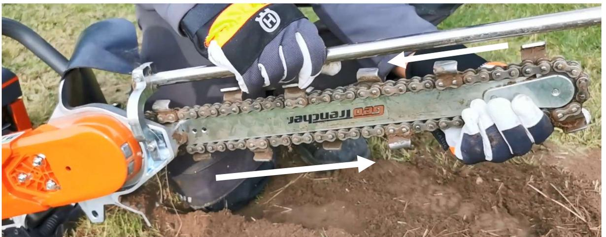
Abbildung 5-7: Anhaftendes Erdreich aus Grabkette und von Werkzeugen entfernen
