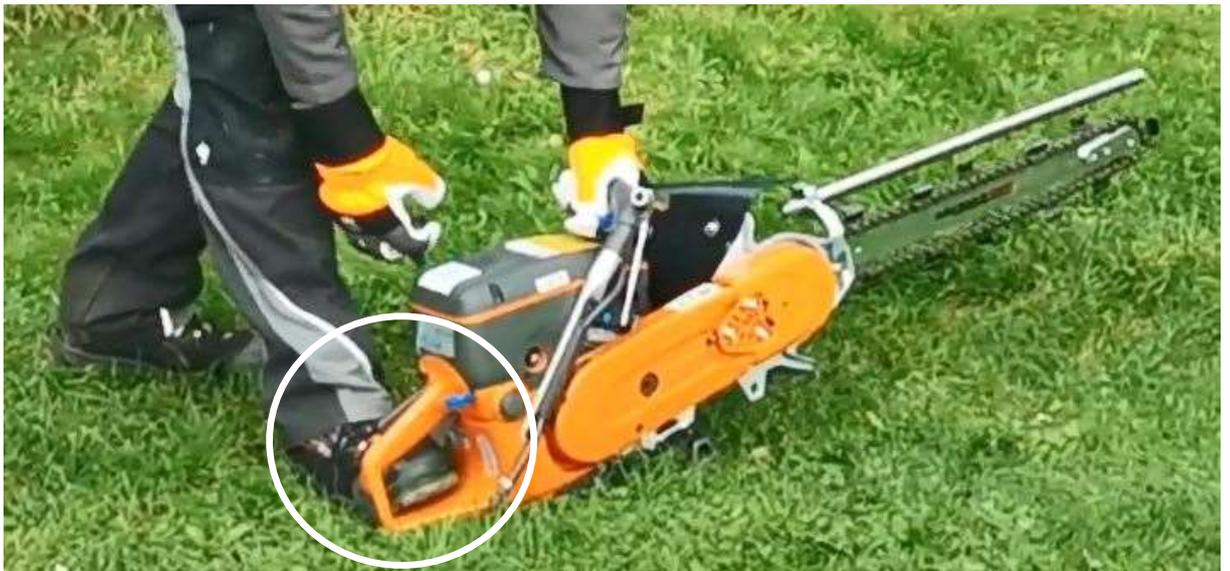
Abbildung 5-1: Grabenfräse GeoTrencher® Antriebsmotor korrekt starten
