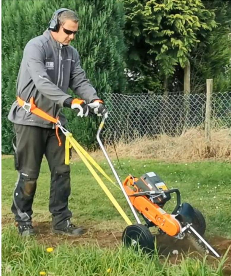
Abbildung 5-4: Arbeitsposition Grabenfräse GeoTrencher mit GeoCart
