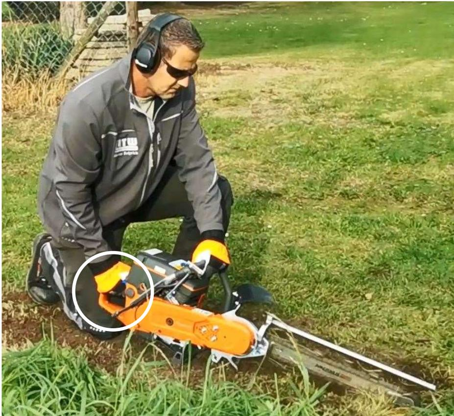
Abbildung 5-2: Grabkette beschleunigen und Grabschiene einstechen
