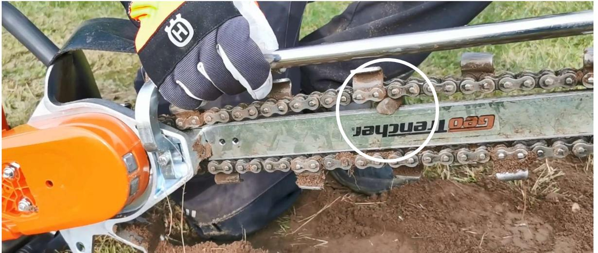
Abbildung 5-6: Steine aus der Grabkette entfernen
