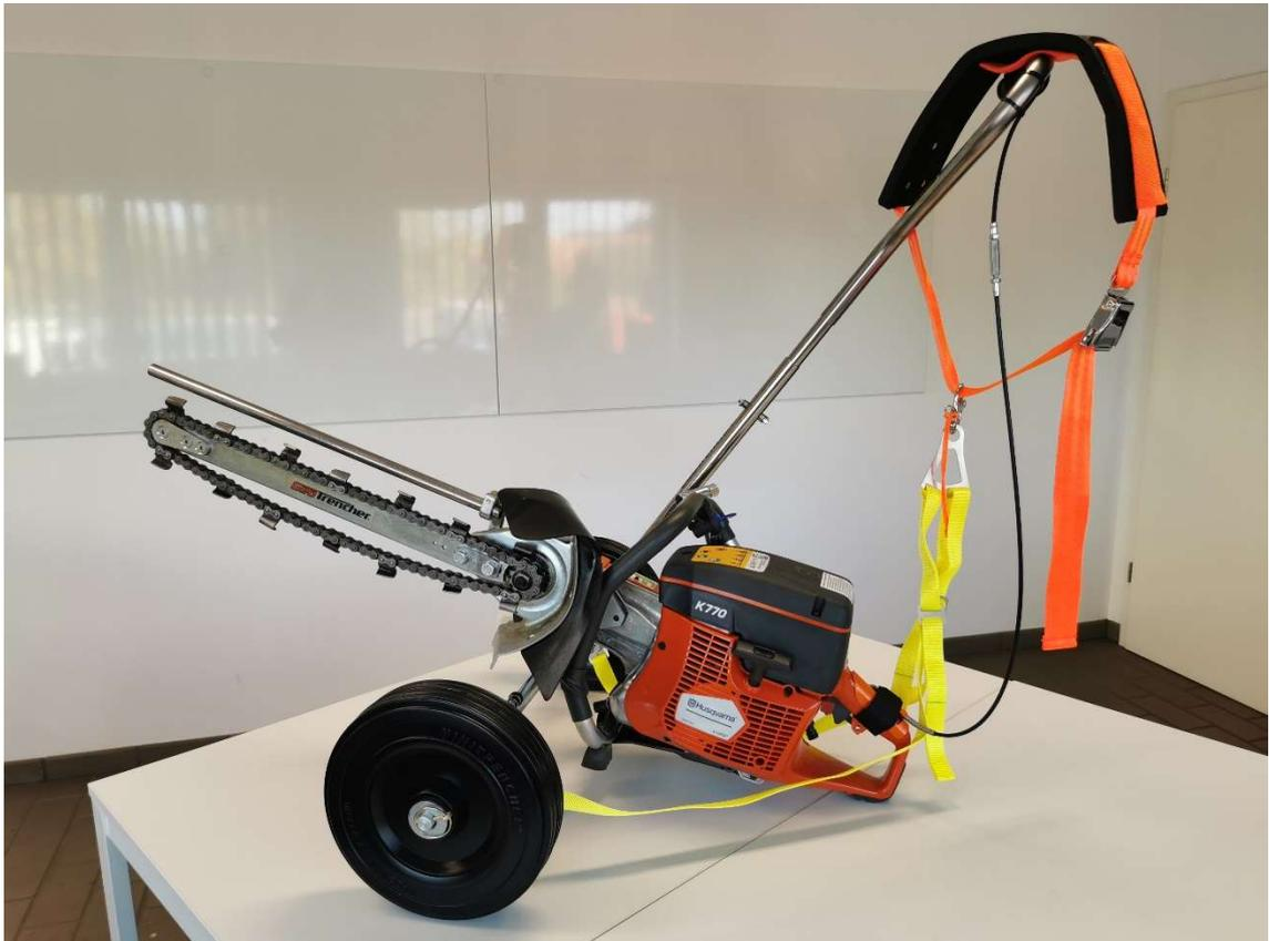
Abbildung 3-4: Grabenfräse GeoTrencher® an GeoCart® montiert
