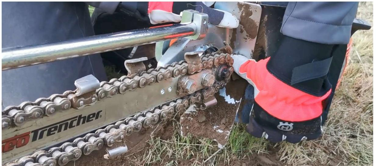
Abbildung 5-5: Antriebskettenrad und Auswurfkrümmer reinigen
